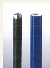
鉛筆と比較した「極細内視鏡」の先端部
